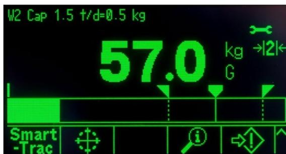
**Figura 1-11: Trasferimento materiale di piccole dimensioni SmartTrac™ attivo**
