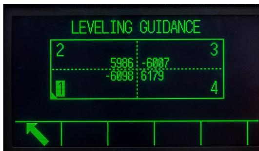
Figura 5-6: Display grafico di Guida al livellamento
