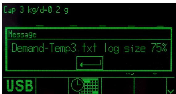
Figura 4-3: Messaggio di avvertenza sulla capacità USB
