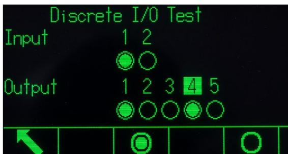
**Figura 5-16: Schermata del test I/O discreto**
