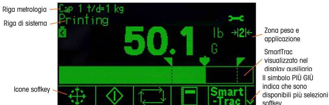
**Figura 2-14: Schermata di inizio predefinita, Riga di sistema con messaggio di stampa visualizzato**
