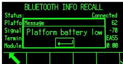
**Figura 2-44: Messaggio di avvertenza sulla batteria**
