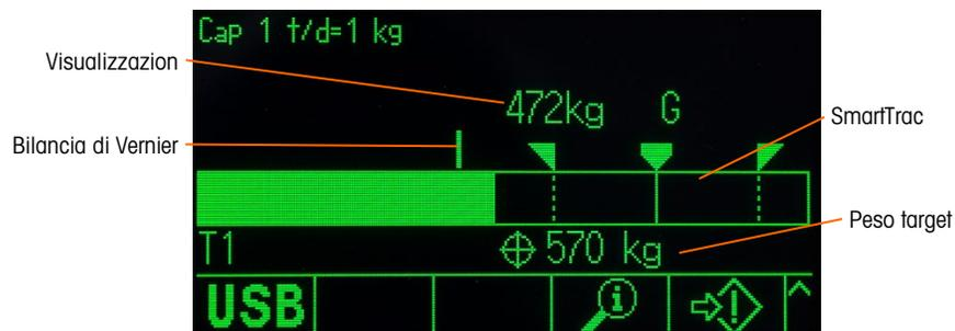
**Figura 2-23: Trasferimento materiale SmartTrac, Medio**
