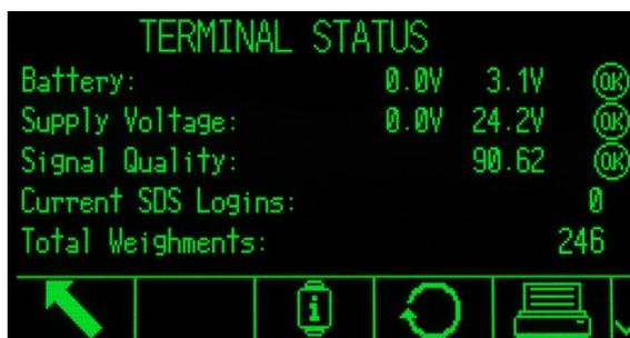
**Figura 4-11: Schermata Stato terminale con icone Ripristino e Cella di carico**
