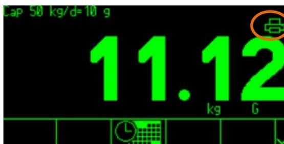
**Figura C-5: stato della connessione della stampante nella linea di sistema**
