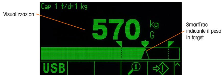
**Figura 2-22: Trasferimento materiale SmartTrac, Piccolo**
