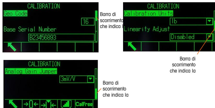
**Figura 2-6: Esempio di barre di scorrimento che indicano tre pagine di campi di configurazione**
