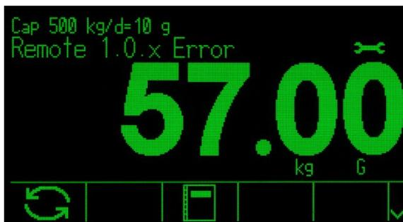
Figura 2-38: Messaggio della riga di sistema di un errore asincrono
