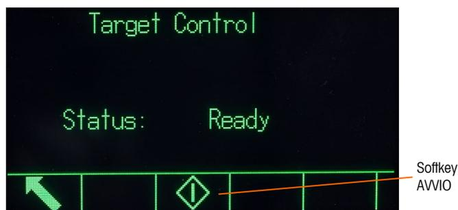
**Figura 2-19: Esempio dello stato Pronto in Controllo target**
