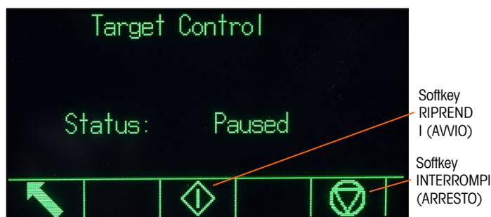
**Figura 2-21: Esempio dello stato In pausa in Controllo target**
