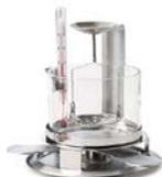
Spezielles Kit zur Dichtebestimmung von Feststoffen und Flüssigkeiten mithilfe einer integrierten Applikation
